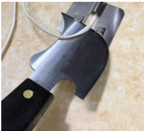
Pilt 1 [ Tekst pildil: esmaseks trimmimiseks kasutage Mozart'i noaga liugurit „0,7 LINO“]
