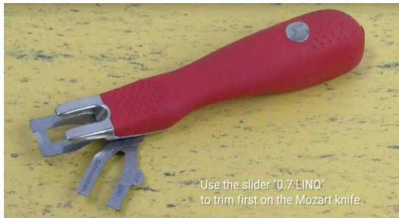
Pilt 1 [ Tekst pildil: esmaseks trimmimiseks kasutage Mozart'i noaga liugurit „0,7 LINO“]
